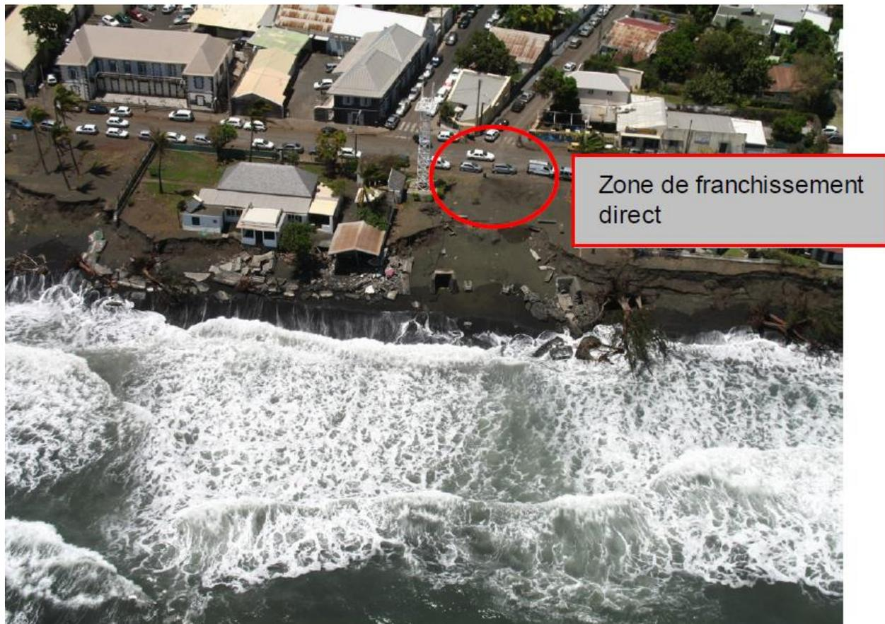
*Figure 34 : Photographie aérienne des impacts de la houle cyclonique et d'une zone de franchissement sur la baie de Saint-Paul (SOGREAH, 2007)*
