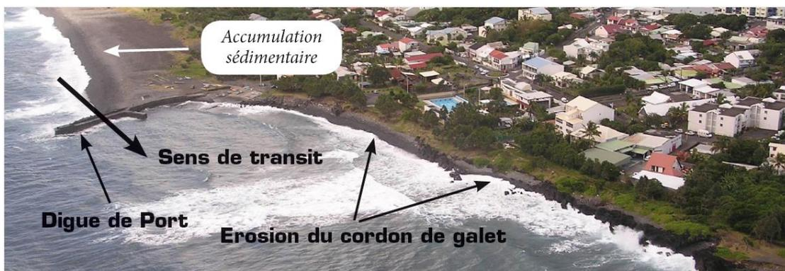
Figure 22 – Exemple de digue bloquant le transit sédimentaire à Saint-Benoît (De La Torre et al, 2012)
